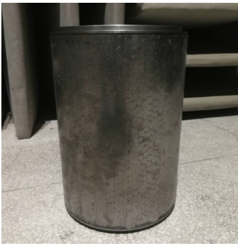
图 2 钛合金环形声衬 Fig. 2 Titanium alloy annular acoustic liner
